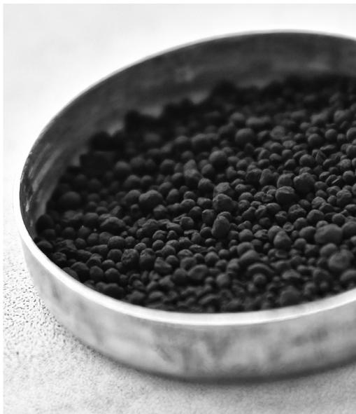
Технический углерод – высокодисперсный аморфный углеродный продукт, производимый в промышленных масштабах, широко используемый в качестве усиливающего наполнителя при производстве резин, чёрного пигмента в производстве печатных красок и лакокрасочных изделий, а также в качестве наполнителя пластмасс и оболочек кабелей для придания им специальных свойств.
